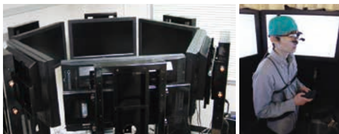
図2 360度視野の視覚探索実験のための装置。被験者は6画面のディスプレイに囲まれて課題を行う。
