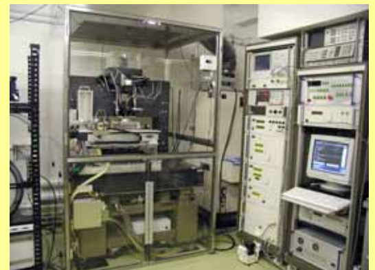
図1 世界最高の測定分解能 (0.001%) を有する LFB超音波材料解析システム
