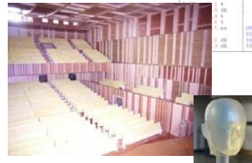
ハイブリッド可聴化で使用した計算モデルおよび縮尺模型
