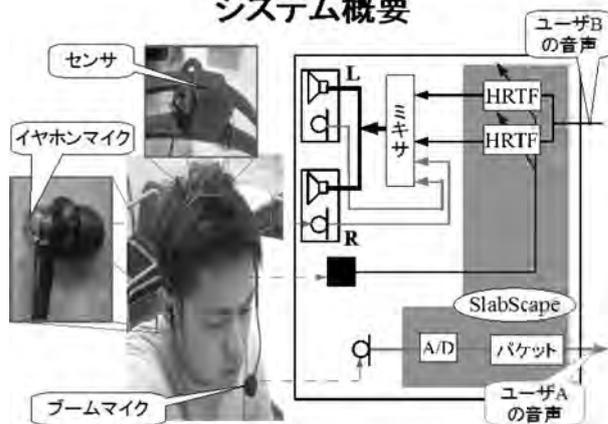
図2 ヘッドトラッカを用いたシステム構成
