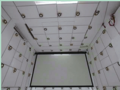
157chの包囲型スピーカシステムを用いたアンビソニックス超高精細音空間再生システム
