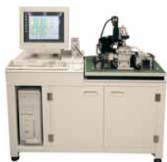
図 1. 実用化第一号走査型非線形誘電率顕微鏡
