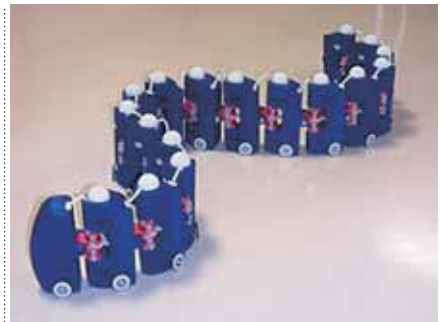
優れた環境適応性と耐故障性を有するヘビ型ロボットの自律分散制御 Ophiroid robot that enables omnidirectional locomotion
