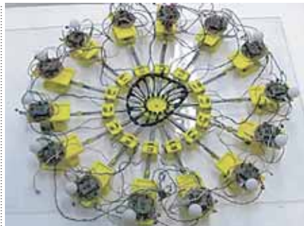
真正粘菌変形体をモチーフとして製作した完全自律分散制御で駆動するアメーバ様ロボット Soft-bodied amoeboid robot driven by a fully decentralized control scheme extracted from true slime mold.
