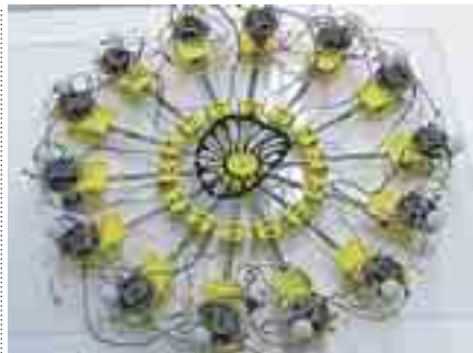
真正粘菌変形体をモチーフとして製作した完全自律分散制御で駆動するアメーバ様ロボット
