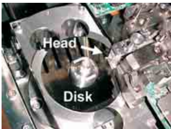
図1 単磁極型記録ヘッドと垂直ディスクを用いた記録再生特性の測定 Fig. 1 Read/write measurement using a single-pole head and a perpendicular medium.
