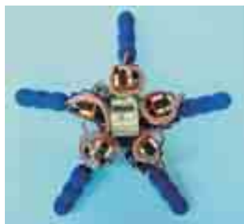
腕を自発的に役割分担して全方向移動可能なクモヒトデ型ロボット
