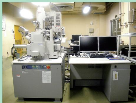
図3 電子ビーム蛍光X線元素分析装置
