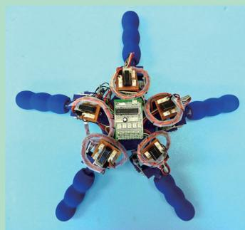
腕を自発的に役割分担して全方向移動可能なクモトデ型ロボット
