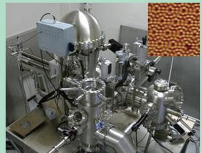
超高真空プロセス・評価一貫装置とSi表面のSTM像(右上)
