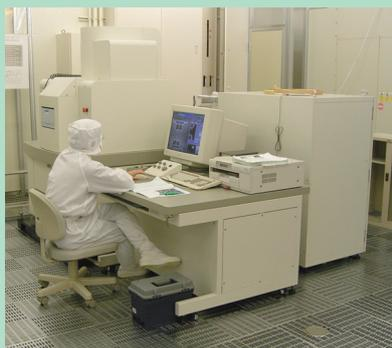
図2 収束イオンビーム加工装置
