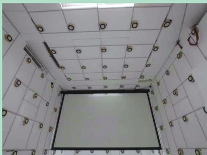
157chの包囲型スピーカシステムを用いたアンビニックス超高精細音空間再生システム
