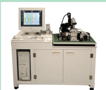
実用化第一号走査型非線形誘電率顕微鏡
