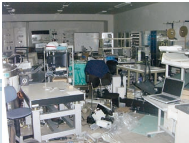
震災直後のナノ・スピン棟 4 階の実験室。実験机の上の装置類は殆ど床に落ち、床に固定していたボンベ立ても固定金具を引きちぎって倒れています。
