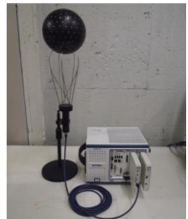
図3 252チャンネル球状マイクロフォンアレイを用いた3次元音空間収音・再生技術 SENZI
