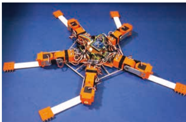
図2: 優れた耐故障性を示すクモヒトデ型ロボット
