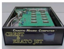
図 2 : (左) 従来のデジタルコンピュータが得意な組合せ最適化問題を、カオス的な迷いと直感で高速に解くカオスニューロコンピュータプロトタイプ (右) 左のプロトタイプを小型化・高速化して大規模な実用問題に対応できるようにするための VLSI チップ
