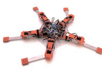
図3. 身体の一部の故障に即座に適応して推進可能なクモヒト型ロボット
