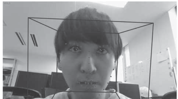
図1 OpenFace による顔特徴の解析。小さな赤四角は、眼、眉、鼻、口、顔輪郭などに関連する特徴点。青線は直方体によって推定された頭部方向を表す。黒眼付近の緑の線は推定された視線方向を示す。
