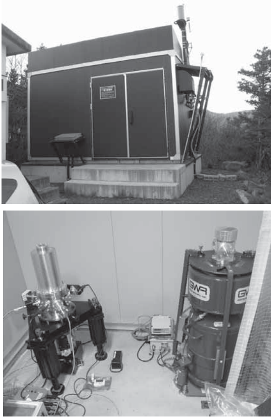
図 4 蔵王観測所 (東北大学大学院理学研究科地震・噴火予知研究観測センター) における観測。上: 観測所外観。下: 左が小型絶対重力計 TAG-1、右が超伝導重力計。
