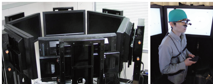
図2 360度視野の視覚探索実験のための装置。被験者は6画面のディスプレイに囲まれて課題を行う。
