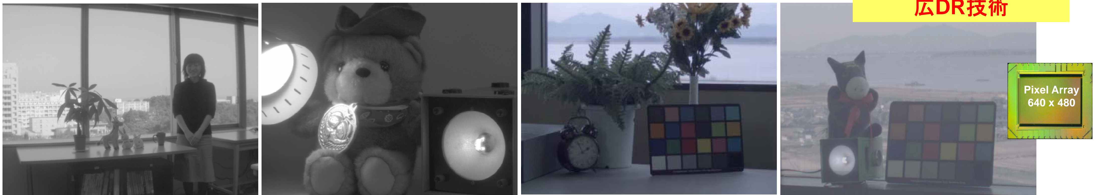
2007 開発のイメージセンサによる撮像例 CG=200μV/e⁻, Noise=2.2e⁻, Q SAT =100ke⁻
