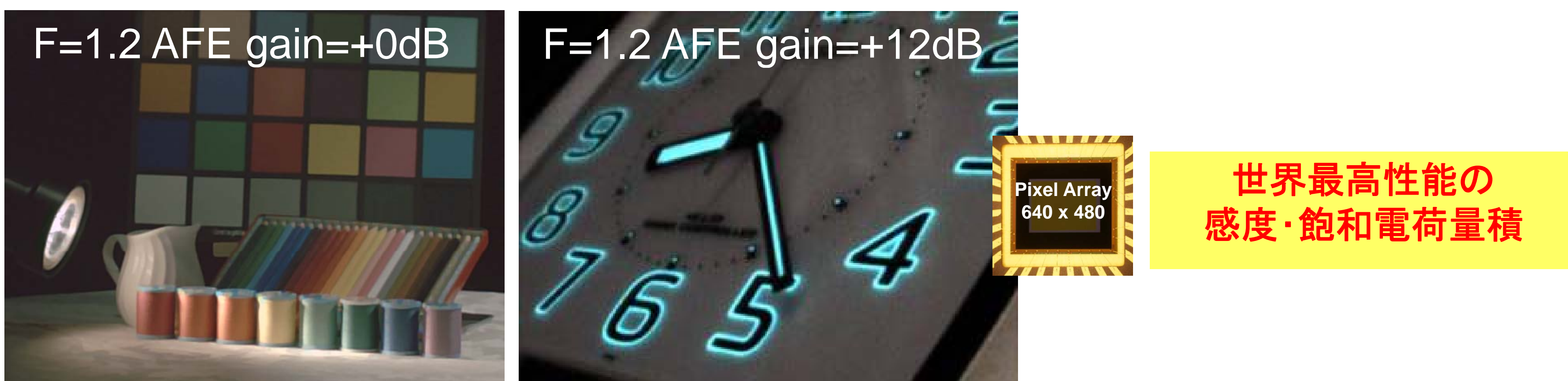
2007 開発のイメージセンサによる撮像例 CG=200μV/e⁻, Noise=2.2e⁻, Q SAT =100ke⁻
