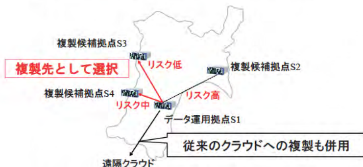
図3: リスクアウェア複製の複製先の選び方 (複製数2, 津波)
