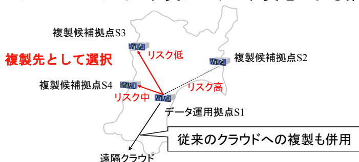
図2: リスクアウェア複製の複製先の選び方 (複製数2, 津波)
