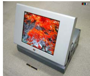
15インチ FSC-OCB モード TFT-LCD
