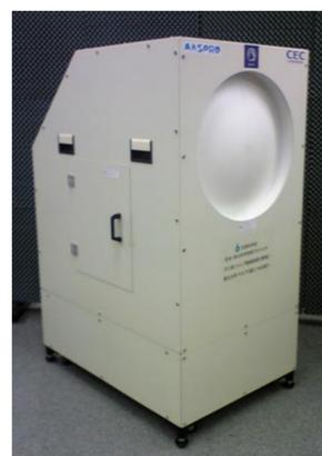
開発した77GHz帯ミリ波パッシブ撮像装置
