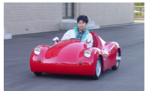
世界初：SRモータによるインホイール式ダイレクトドライブ電気自動車 ※JFE, ENAXとの共同研究
