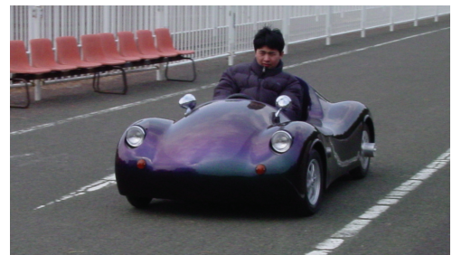
世界初：SRモータによるインホイール式ダイレクトドライブ電気自動車 ※JFE, ENAXとの共同研究
