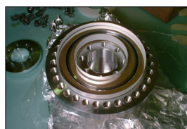
絶縁体に石英板を用いメタルリングで封止することによりガス放出を低減
