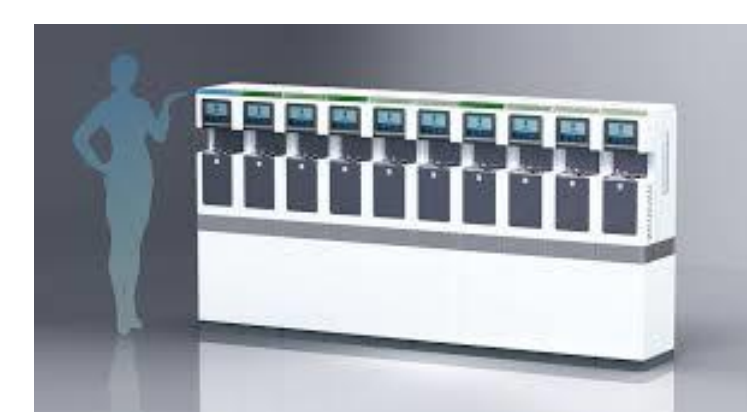
多品種少量生産向けのミニマルファブの装置開発 (エッチング、スパッタリング装置)
