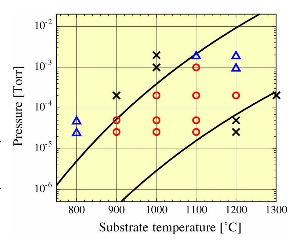
2. Si基板上SiC薄膜表面のエピタキシャルグラフェン形成過程
