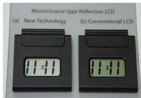
モノクロ式の反射型液晶パネルの比較
