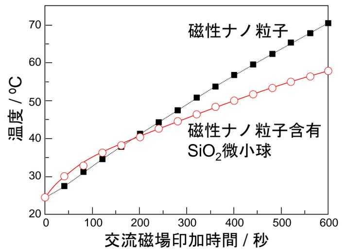
図5 寒天中に分散させた磁性ナノ粒子および磁性ナノ粒子含有 $\text{SiO}_2$ 微小球の100 kHz、300 Oeの交流磁場下における発熱特性
