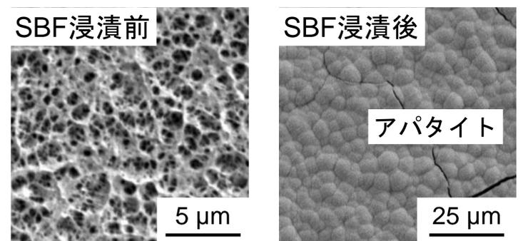
図6 NaOH-温水-アンモニア加熱処理したチタンのSBF浸漬前後のSEM写真
