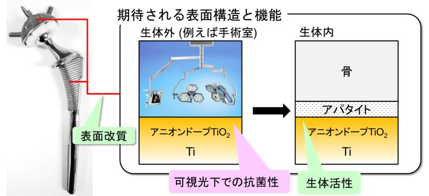
図2 可視光応答型抗菌性チタン
