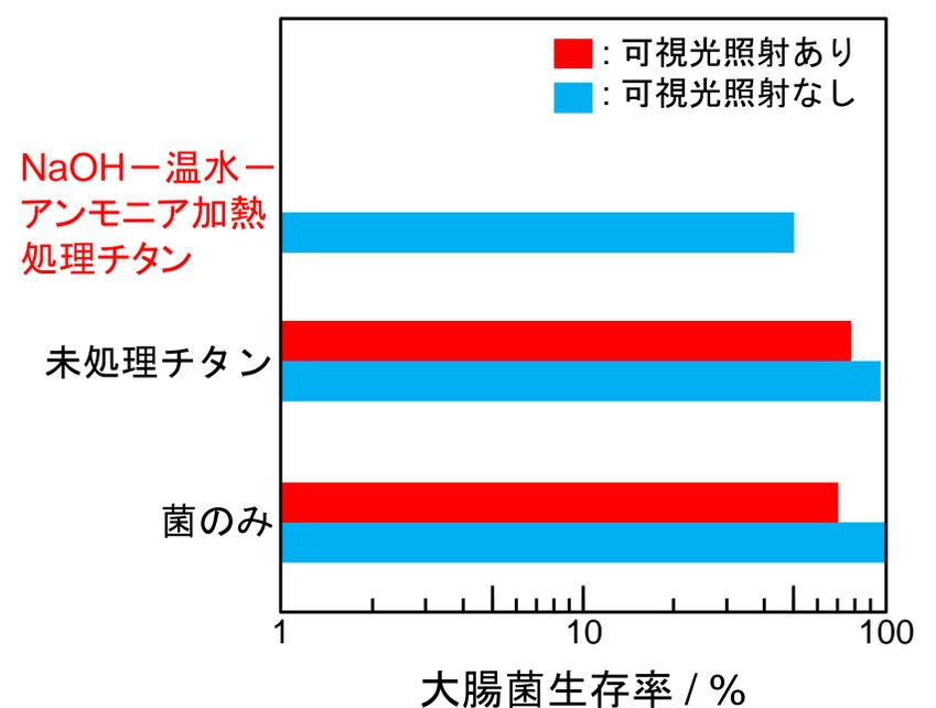
図7 NaOH-温水-アンモニア加熱処理したチタンの抗菌性
