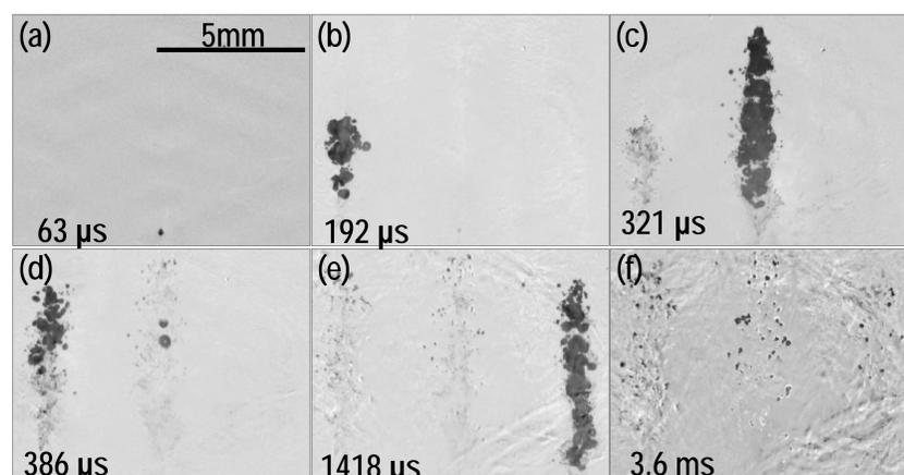
図5 集束超音波焦点の電子走査によって、ゲル中の3箇所が発生させたキャビテーション気泡群の高速度撮影結果
