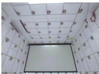
157chの包囲型スピーカシステムを用いたアンビソニックス超高精度音空間再生システム
