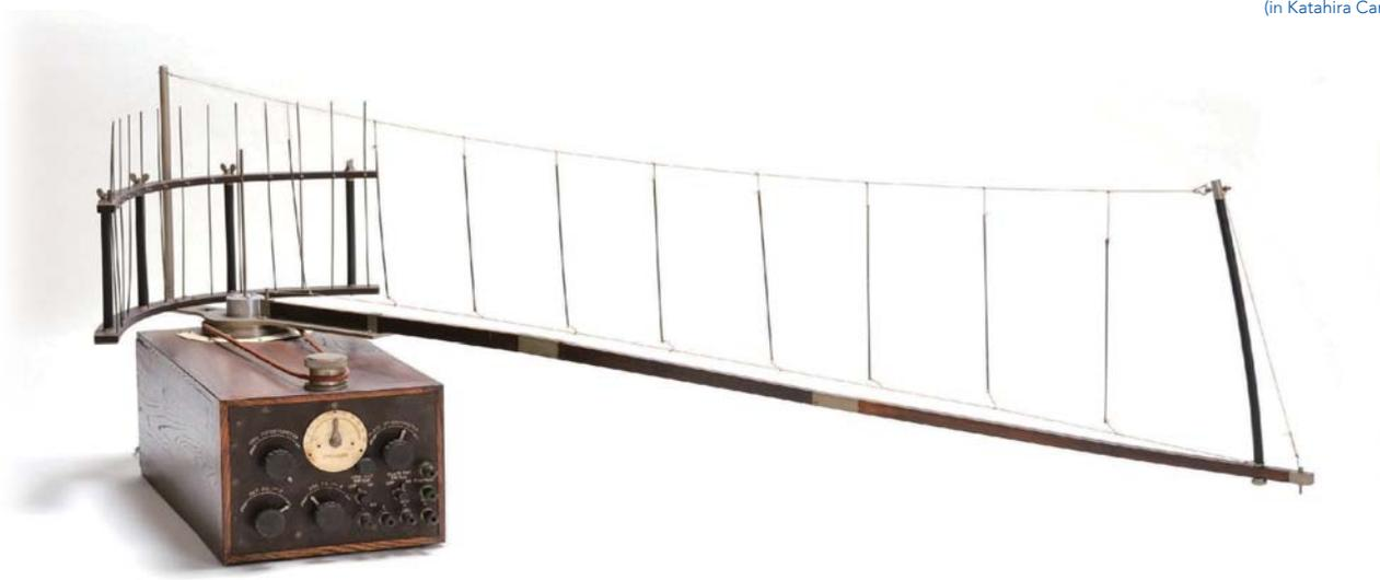
八木・宇田アンテナの実験装置 (1929)
