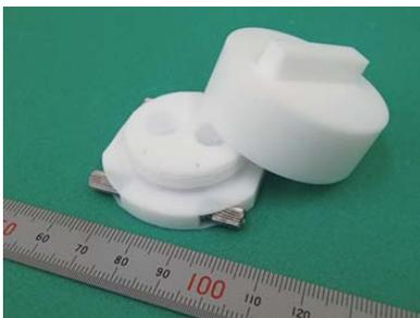
図1 人工細胞膜計測用テフロン
