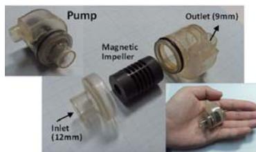
完全埋め込み型補助人工心臓用小型ワイヤレスポンプのプロトタイプ
