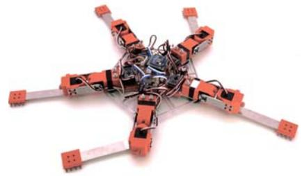
図3. 身体の一部の故障に即座に適応して推進可能なクモヒトデ型ロボット
