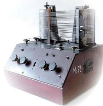
交流バイアス方式による磁気記録装置 (1937)
