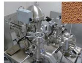
図3. 超高真空プロセス・評価一貫装置とSi表面のSTM像(右上)
