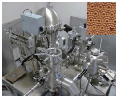
図2. 超高真空プロセス・評価一貫装置とSi表面のSTM像 (右上) Fig2. A UHV-compatible process/analyses system and the STM image of a Si surface (inset).
