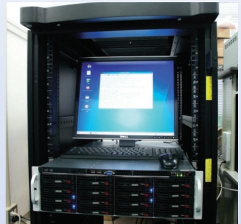
図2 多数のHDDで構成されるRAIDシステム
