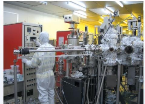
III-V 族ベースの強磁性半導体および金属磁性体素子を成膜する分子線エピタキシスパッチシステム
