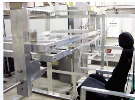
図1 ハーフミラー型視覚刺激提示装置
