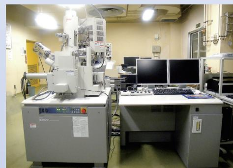
図3 電子ビーム蛍光X線元素分析装置
