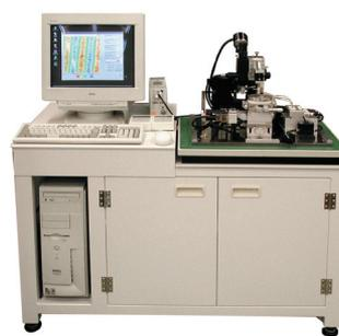
実用化第一号走査型非線形誘電率顕微鏡
