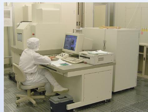
図2 収束イオンビーム加工装置
