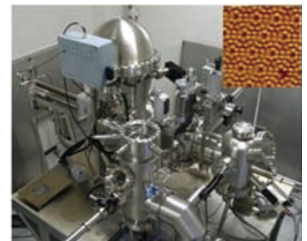
超高真空プロセス・評価一貫装置とSi表面のSTM像(右上)
