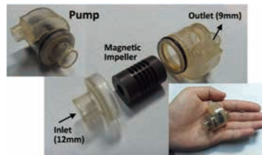
図1 射出成型磁石インペラを用いたワイヤレス駆動可能な補助人工心臓ポンプの試作品
