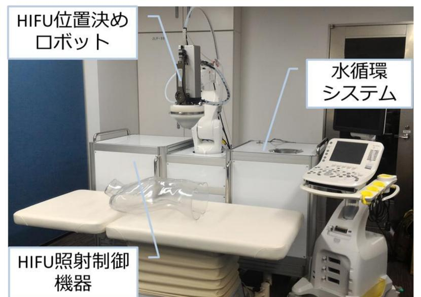
図4：開発した臨床試験機
