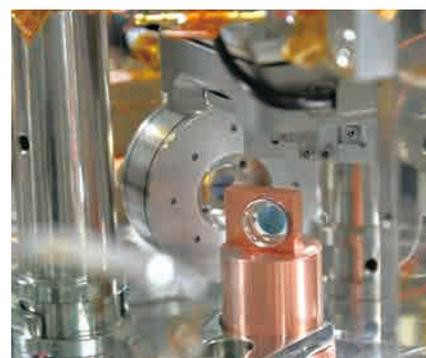
図 2. 開発したセンサー。懸架鏡を一端とした光共振器で構成され、懸架鏡の位置の変位を光共振器を通過するレーザー光により計測します。
