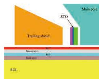
マイクロ波アシスト方式垂直記録の構造
