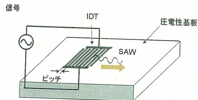
IDT (すだれ状電極変換器)
