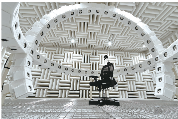
無響室に設置されたスピーカアレイを用いて、空間に分布した様々な音の中から聴きたい音を選択的に聴き分けるメカニズムを明らかにしています。 By using this loudspeaker array installed in an anechoic room, we investigate how people extract target sounds from spatially distributed distractors.
