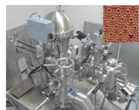
超高真空プロセス・評価一貫装置と Si 表面の STM 像 (右上) A UHV-compatible process/analyses system and the STM image of a Si surface (inset).
