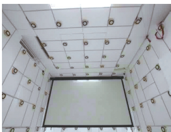
157chの包囲型スピーカシステムを用いたアンビソニックス超高精細音空間再生システム Accurate sound space communications system based on higher order Ambisonics by using 157ch loudspeaker array
