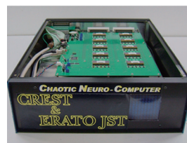
図2：(左) 従来のデジタルコンピュータが得意な組合せ最適化問題を、カオス的な迷いと直感で高速に解くカオスニューロコンピュータプロトタイプ (右) 左のプロトタイプを小型化・高速化して大規模な実用問題に対応できるようにするためのVLSIチップ Fig. 2 (Left) A chaotic neuro-computer proto-type system for quadratic assignment problems, which uses chaotic wanderings and inspirations to find solutions. (Right) A dedicated VLSI chip for a fast and practical large-scale chaotic neuro-computer system which can solve real-world problems.
