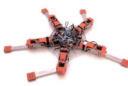
図3. 身体の一部の故障に即座に適応して推進可能なクモヒトデ型ロボット
