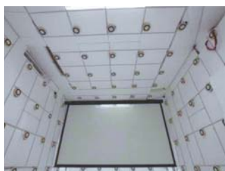
157chの包囲型スピーカシステムを用いたアンビソニックス超高精度音空間再生システム Accurate sound space communications system based on higher order Ambisonics by using 157ch loudspeaker array
