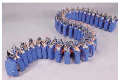
図1. 優れた環境適応性を有するヘビ型ロボットの自律分散制御
