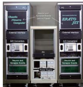
図1：(左) カオスニューロチップ (右) 1万個のニューロンを1億個のシナプスで結合可能な大規模汎用カオスニューロコンピュータハードウェアシステム
