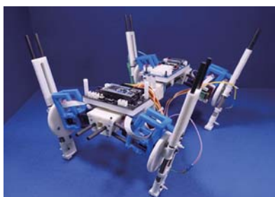
図2. 環境や身体変化に応じて自己組織的に歩行変化が変化する四脚ロボット
