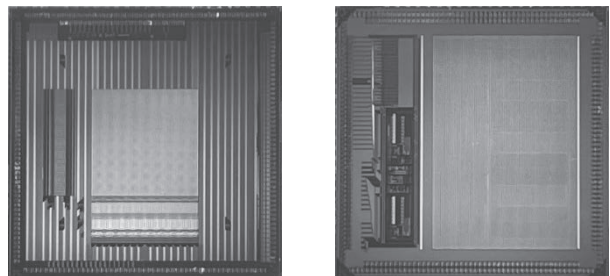
図 3 : 3 次元積層 LSI を実装する LSI 左 : ニューロン IC 右 : 結合重みメモリ IC
