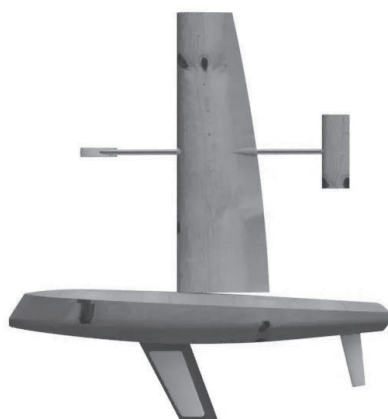
Figure 2 エバーブルーテクノロジー社と共同開発する帆走ドローン「Type-M」の試作
