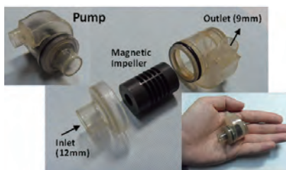
完全埋め込み型補助人工心臓用小型ワイヤレスポンプのプロトタイプ A prototype of wireless artificial heart assist blood pump
