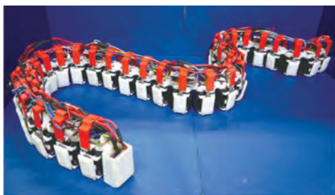
図 1. 優れた環境適応性を有するヘビ型ロボットの自律分散制御 Fig.1 Autonomous decentralized control of a snake-like robot that exhibits highly adaptive properties.
