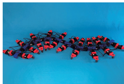
図 3. 多様な脚・胴体間協調パターンを発現可能なムカデ型ロボット Fig.3 Centipede-like robot that can generate versatile body-limb coordination patterns.
