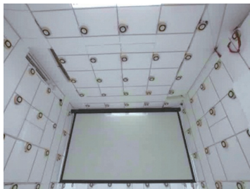
157chの包囲型スピーカシステムを用いたアンビソニックス超高精細音空間再生システム Accurate sound space communications system based on higher order Ambisonics by using 157ch loudspeaker array
