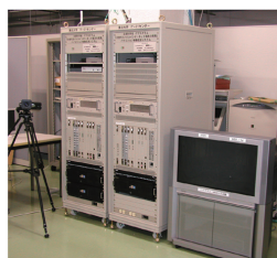
Fig.1 5GHz 帯 324Mbit/s 無線 LAN 端末 Fig.1 5 GHz-Band 324 Mbit/s Wireless LAN terminal
