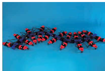
図3. 多様な脚・胴体間協調パターンを発現可能なムカデ型ロボット
