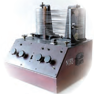
交流バイアス方式による磁気記録装置 (1937) Experimental equipment for AC-bias magnetic recording (1937)
