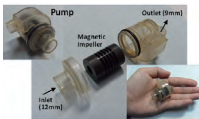
完全埋込み型補助人工心臓用小型ワイヤレスポンプのプロトタイプ A prototype of wireless artificial heart assist blood pump
